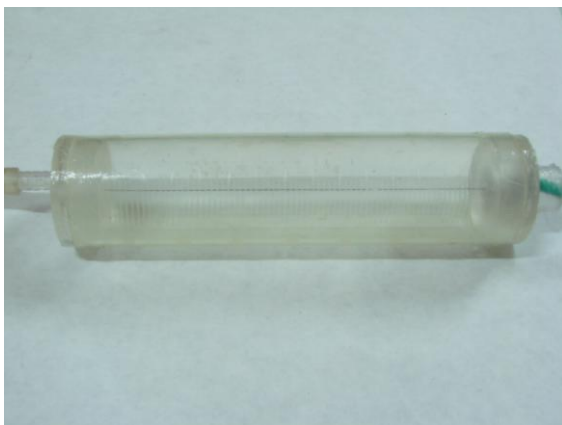
Fig. 5. Generarea de plasmă non-termică pulsată cu o structură fir-plan. Gaz de lucru: He, 4 l/min.
