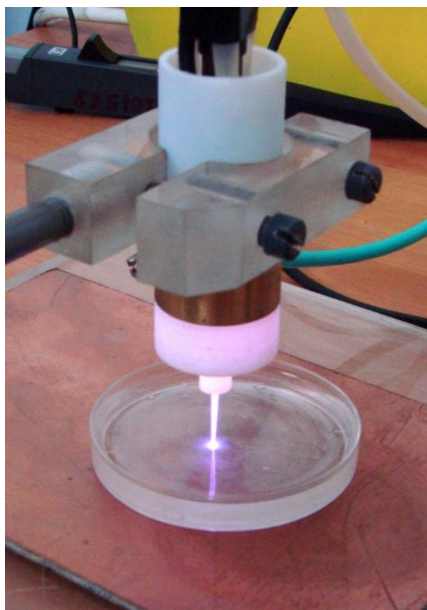
Fig. 8. Varianta finală a dispozitivului cu trei electrozi de înaltă tensiune, alimentați în paralel.
