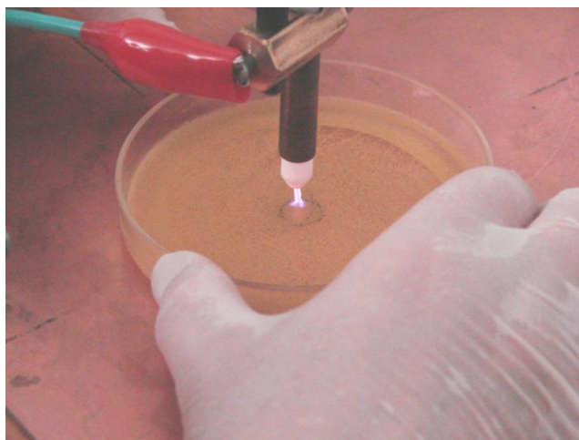
Fig. 22. Distrugere de microorganisme cu jet de plasmă pulsată la presiune atmosferică.
