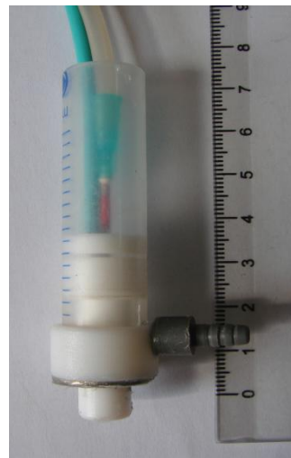
Fig. 1. Schița și fotografia dispozitivului tip “siringă” pentru generarea jeturilor de plasmă rece pulsată la presiune atmosferică.
