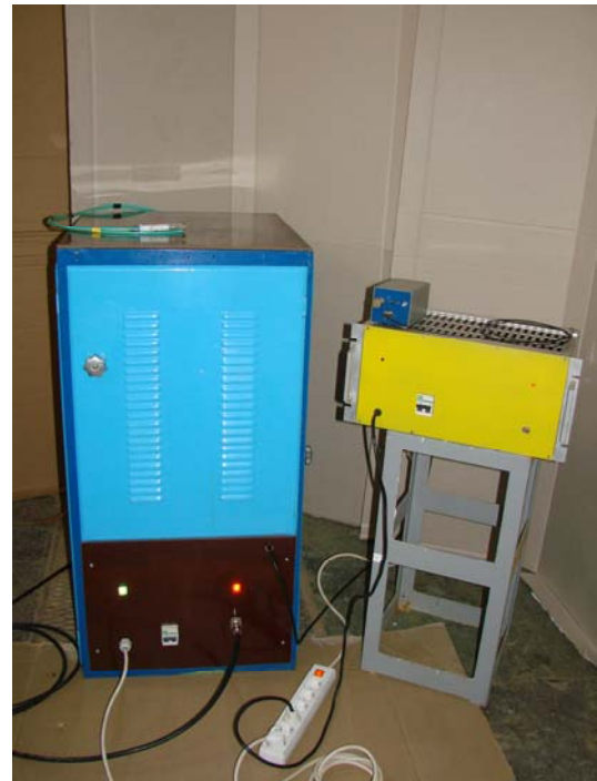
Fig. 2. a) Componentele esențiale ale modelului experimental al generatorului de impulsuri electrice repetitive, de înaltă tensiune, care alimentează dispozitivul emițător de jeturi de plasmă rece la presiune atmosferică. b) Ansamblul generatorului de impulsuri electrice repetitive, de înaltă tensiune: modulul albastru – generatorul propriu-zis; modulul galben: generatorul impulsurilor de declanșare tiratron.
